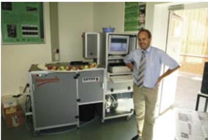
Dr. Dirk Köpcke, Leiter der Abteilung Fruchtqualität und Obstlagerung, präsentiert die Primprenelle im Labor des OVB Jork. Mit diesem Analyseautomaten können jeweils 30 Äpfel auf Fruchtfleischfestigkeit, Zuckergehalt, Säuregehalt, Saftigkeit und Fruchtgewicht untersucht werden.
